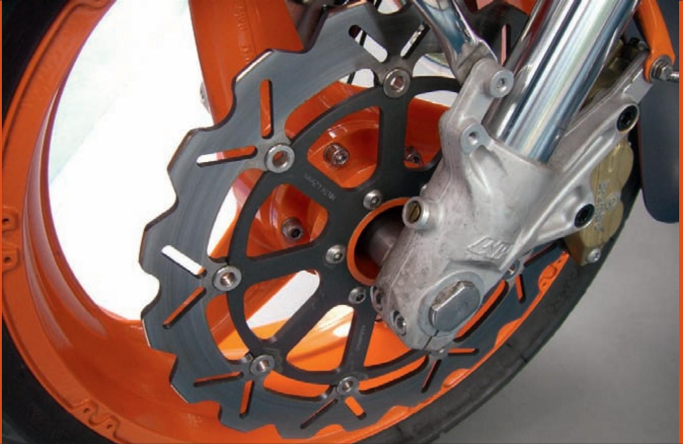
Licht und Schatten liegen bei dem Renn-Brems-System der Spitzenmodelle des ehemaligen Herstellers Triketec dicht beieinander. Hervorragende Bremsleistungen (überlegener Sieger beim Vergleichstest des TRIKE-Magazins 2005) standen auf der Positivliste. Zahlreiche Probleme wie klemmende, verkantete Bremskolben, nicht fluchtende doppelte Vierkolben-Bremssättel, klappernde schwimmende Bremsscheiben und eine hohe unangenehme Geräusentwicklung beim Bremsvorgang trübten die Freude über
